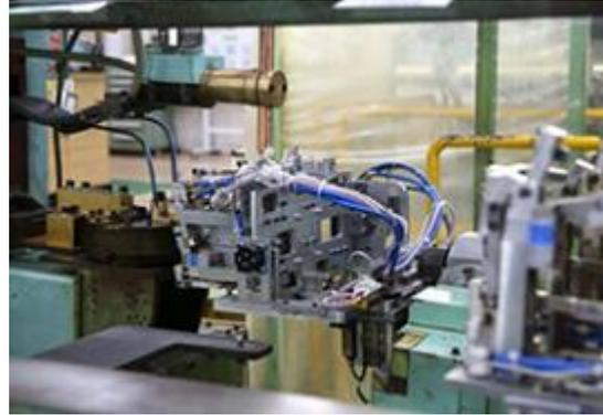
スポット専用溶接ロボット
