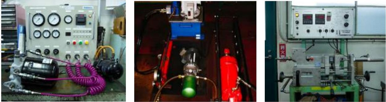
多様な試験機（左からエアードライヤー、油圧シリンダ、パワーシフト試験機）
