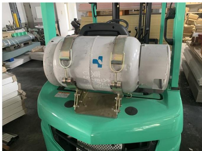
当社では、ガソリン車に比べて排気ガス中のCO（一酸化炭素）、HC（炭化水素）、NOX（窒素酸化物）が1/3～1/6程度と言われるLPGフォークリフトを採用しており、環境負荷低減に寄与している。また、オイル交換も少なく、エンジン寿命も長いという特性もあり、製品ライフサイクルを長期化させることでも貢献している。
