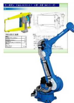
溶接ロボット
