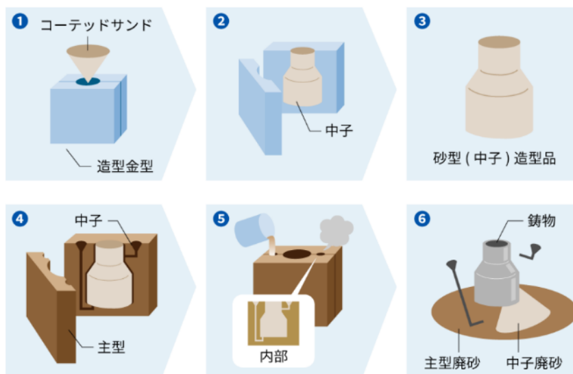
コーテッドサンドから中子の成形、鑄物の製造
