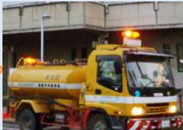
②散水車による事前の水撒き
